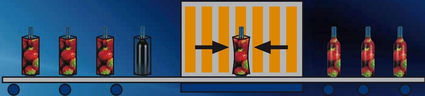
**Retracción por calor de la etiqueta tubular**
