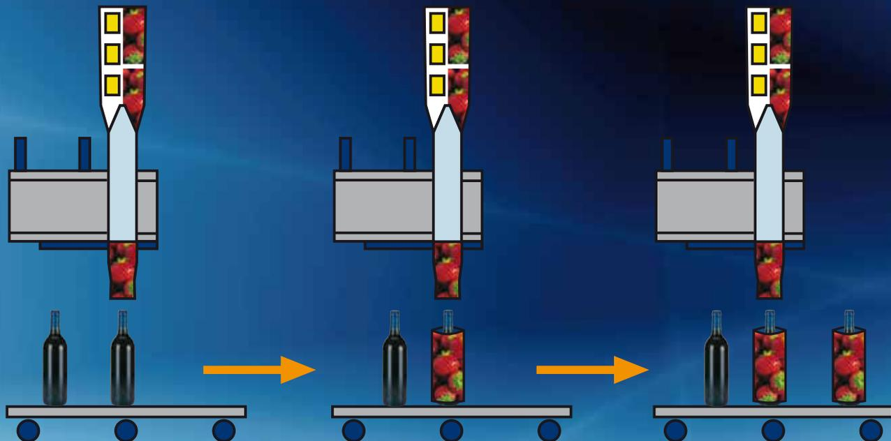
**Sellado etiqueta tubular retráctil y colocación previa al retractilado**
